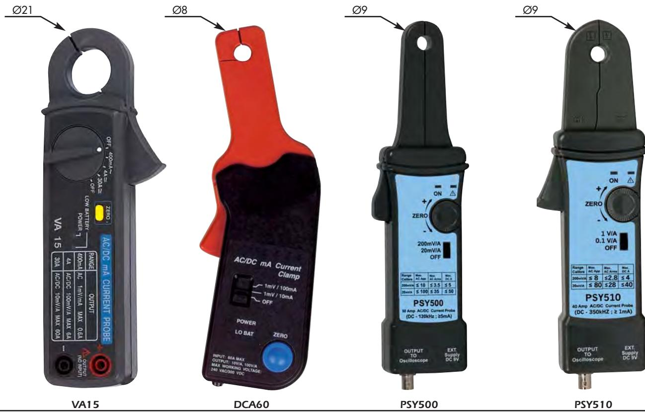
Ces sondes s'utilisent avec un oscilloscope, un multimètre ou un enregistreur. Elles délivrent une tension secondaire image du courant primaire de quelques dizaines de millivolts, permettant des mesures en toute sécurité et sans coupure du circuit. Le capteur Hall qui les équipe détecte une composante continue superposée à la composante alternative. Utilisées avec un multimètre efficace vrai, ces sondes affichent une mesure de courant efficace vrai.
