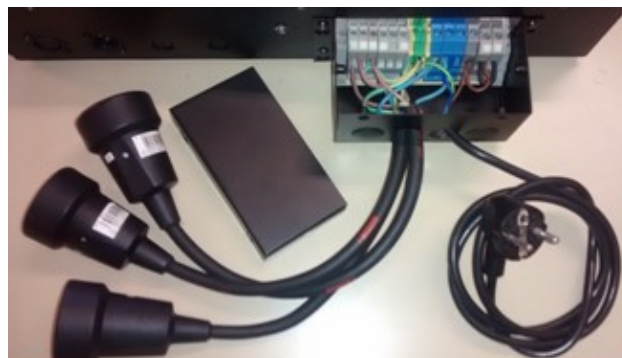
Figure 2 : bornier de protection du DP615
