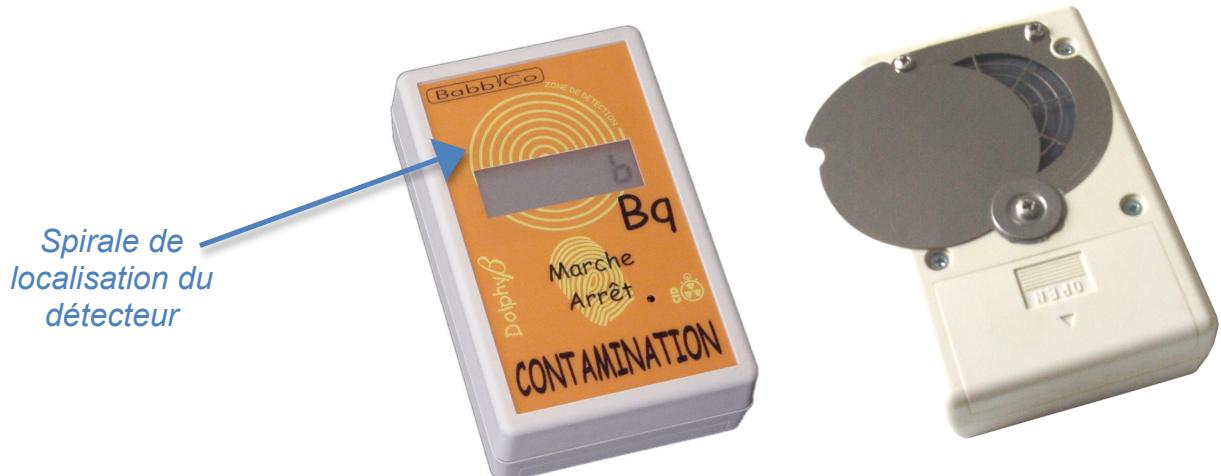
La surface sensible du détecteur est de  $15,9 \text{ cm}^2$  pour un détecteur dont le diamètre de la surface sensible est de 44,5 mm et dont la profondeur effective est de 12,7 mm.
