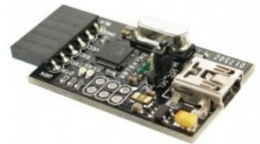
Figure 9 : adaptateur USB/RS232 USB2Serial Light
